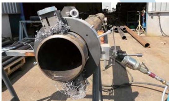
TT273 切割開槽機與氣動驅動
