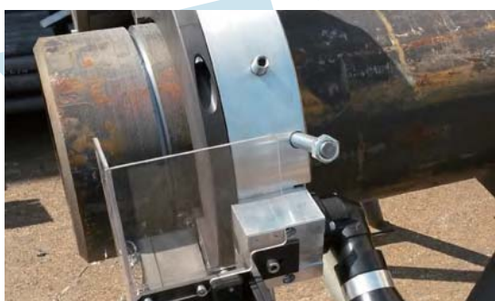
TT219 切割開槽機與氣動驅動
