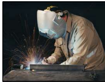
傳統的CV短路傳輸使用二氧化碳(CO 2 )和0.045in.實心線。
