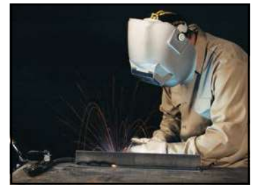
使用CO 2 和0.045in.實心線進行STT。(注意減少飛濺和煙塵)。
